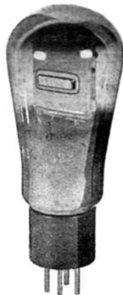
Bild 1. Das Kästchen auf der Anode ist ein Zeichen dafür, daß es sich um eine Röhre mit Bariumdampfkathode handelt.
